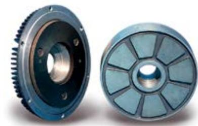
O ímã permanente, magnetiza a placa induzida, gerando assim um anel de alternância de polaridade e as forças magnéticas necessárias para transmitir o torque.
